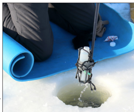
Le creusage d'un trou dans la glace a permis la prise d'un échantillon d'eau au lac Saint-Augustin.
