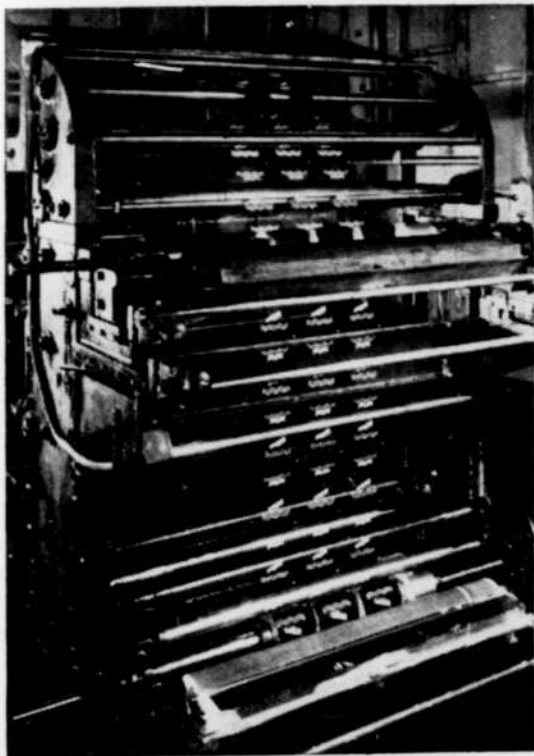
Cette photo montre deux des cylindres en aluminium utilisés dans l'une des presses de Perkins.
