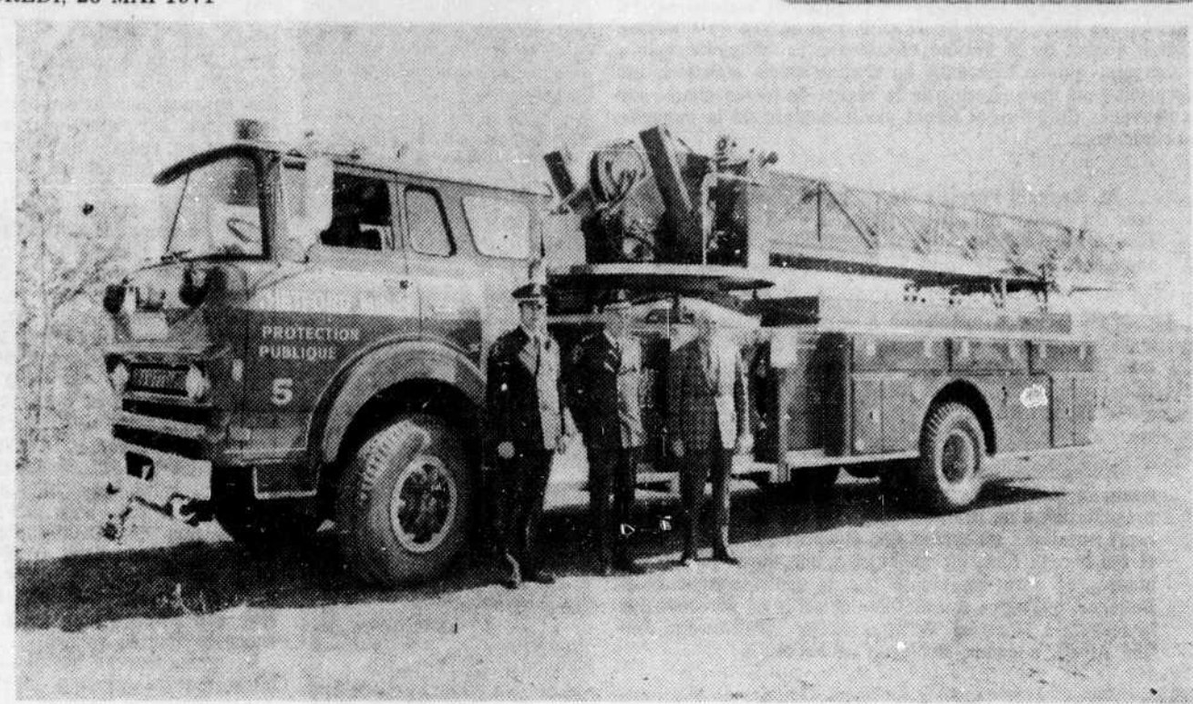
Ce camion à incendies est la toute nouvelle acquisition du Service de la protection publique de la cité de Thetford Mines. Pesant 36,000 livres, il est doté d'une échelle de 100 pieds. Sa pompe peut également fournir 840 gallons à la minute. (Photo Studio Jean-Charles Poulin)
