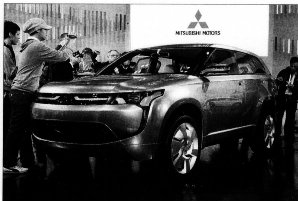
Le concept PX-MieV de Mitsubishi est un multisegment hybride qui dispose de deux moteurs électriques. Le premier entraîne les roues avant, le second se charge de l'essieu arrière. Chacun revendique une puissance de 60 kW, soit l'équivalent d'environ 82 chevaux.
