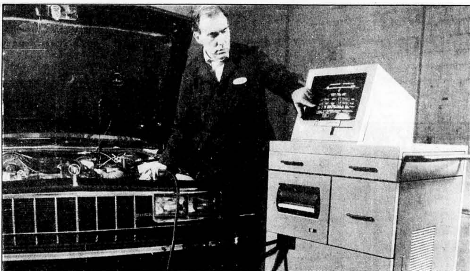
Cet ordinateur mobile très simple à utiliser s'appelle CAMS. Il a été mis au point par Buick en collaboration avec IBM. Dorénavant, le mécanicien est en mesure de détecter rapidement et sûrement la cause des principales déficiences mécaniques. L'ordinateur fournit même les solutions aux problèmes...
