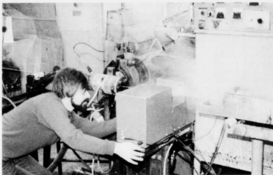
Figure 1: Essais à l'usine de prototype IGM pour le contrôle de la rugosité de fils électriques enrobés de polymères en cours d'extrusion.
