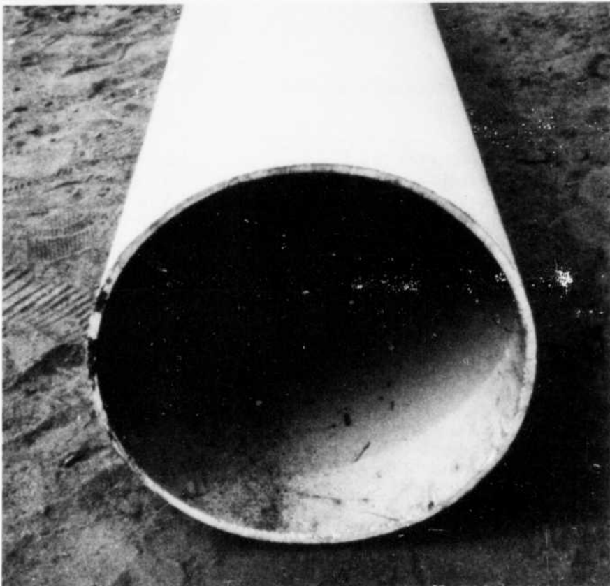
Figure 1 Poteau creux en résine polyester renforcée de verre destinée aux compagnies de téléphone.
