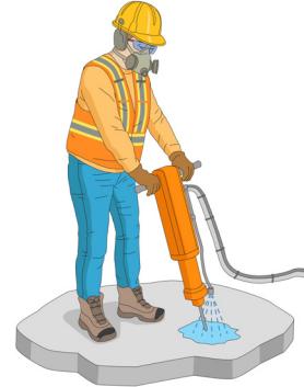
Figure 13 : Marteau-piqueur muni d'un système d'apport d'eau
