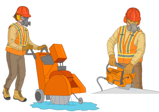
Figure 12 : Scies munies d'un système d'apport d'eau
