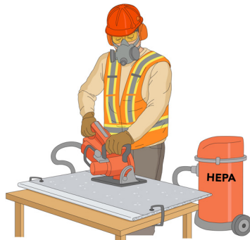
Figure 10 : Scie munie d'un système d'aspiration avec filtre HEPA
