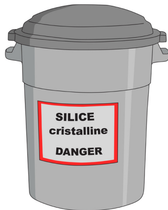
Figure 14 : Contenant de débris de silice cristalline
