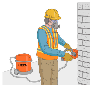
Figure 11 : Meuleuse munie d'un système d'aspiration avec filtre HEPA
