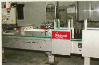
La nouveauté sur ce poste de réception des œufs, c'est le transfert automatique des œufs.
