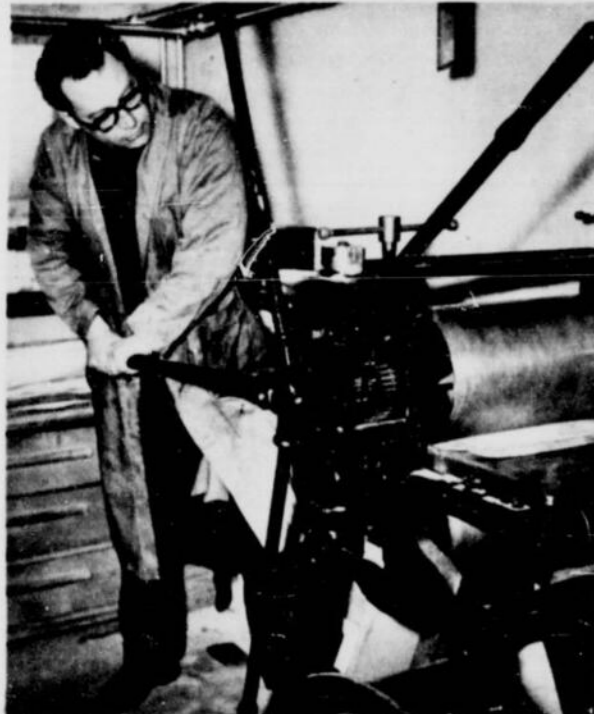
M. Dumouchel travaille ici à la presse à taille douce pour les gravures à eau-forte.
