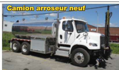
Camion arroseur neuf FREIGHTLINER M2-106V 2011, Cummins ISC 300 hp, Allison 3500RDS, ess. 18 000/40 000 lb, full lock. Citerne aluminium poli 14 000 l, pompe entraînement hydraulique contrôlée par moniteur IQAN, 4 buses d'arrosage, un dévidoir et un bras Tenco PCL500, flèche arrière et caméra de recul. Contactez Yves Talbot 514-645-4587 poste 280
