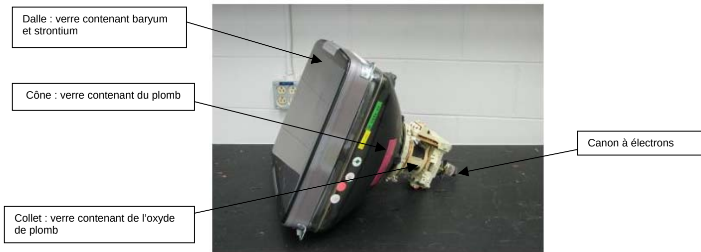
Photo 1 : Les principaux composants du tube cathodique
