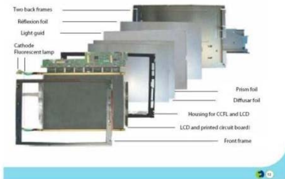
Figure 4 : Présentation de la constitution d'un écran LCD 69
