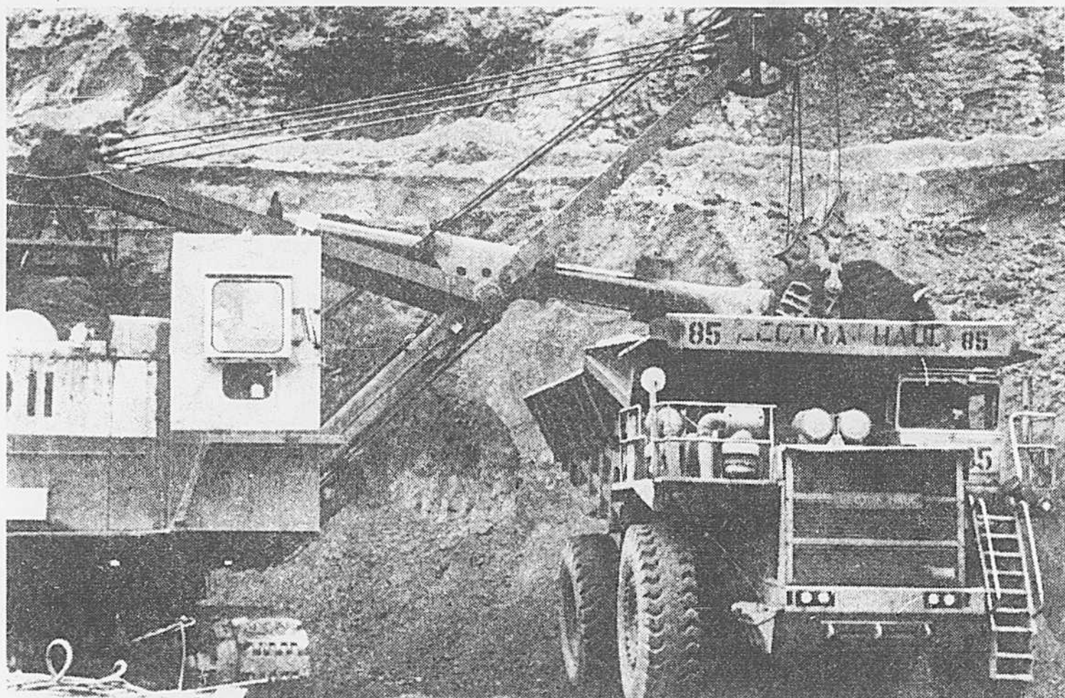
Les pelles mécaniques sont mues à l'électricité dans les mines de l'Iron Ore.
