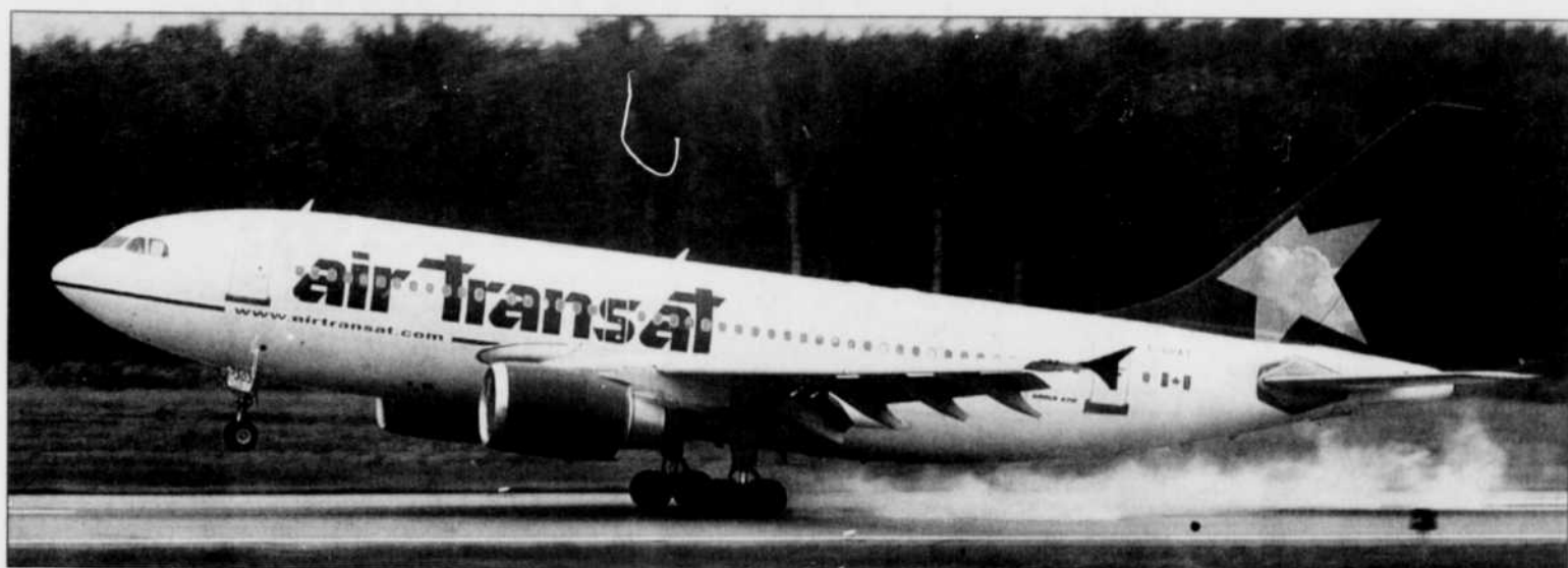
C'est la partie mobile, derrière la queue de l'appareil, qui sert de gouvernail. C'est cette pièce imposante qui s'est désagrégée en vol.
