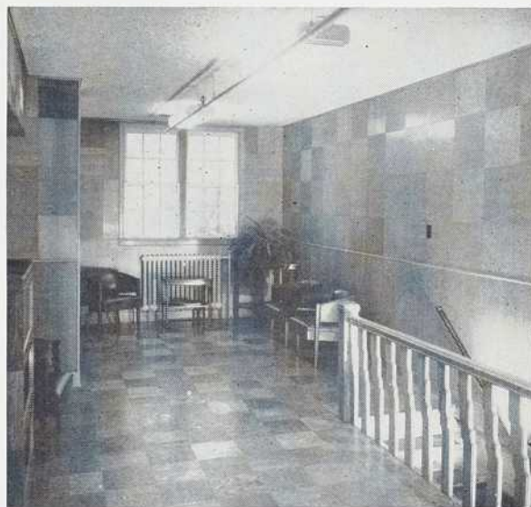
Salle de réception en carrelages de chêne blanc tranché sur maille. Par- quet en carreaux de chêne rouge déroulé. Immeuble Commonwealth Plywood Co. Ltd., Ste-Thérèse, P.Q.
