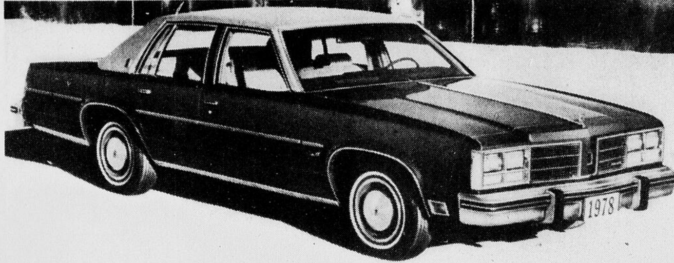
DELTA 88 — Cette voiture Oldsmobile peut être équipée du diesel. Mais son moteur standard est un V6 de 3,8 litres (231 pouces cubes).
