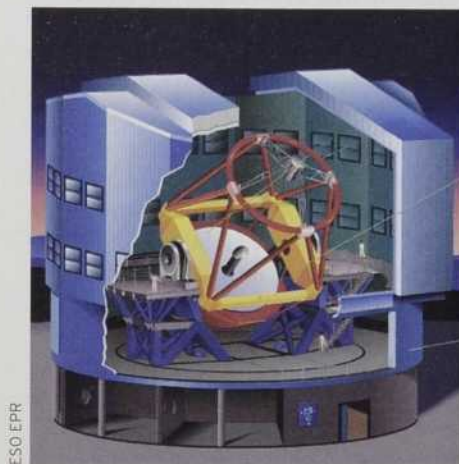
Une coupe profilée de l'enceinte du télescope VLT sur le mont Paranal. Son miroir (à droite) est un des plus performants jamais construit. Il fait 8,2 mètres de diamètre. Il est doté d'instruments de précision (à l'extrême droite).
