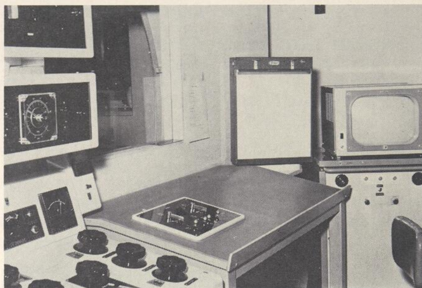
Fig. 4 — Sur cette photo nous remarquons: 1) l'écran de T.V. sur lequel le radiologue suit la progression de l'opacification des voies biliaires; 2) les commandes destinées soit à prendre des clichés "standard", soit à filmer à la demande, soit à changer la position de la table de cinéradiographie; 3) la baie vitrée à travers laquelle le radiologue observe le malade et le déroulement des opérations.
