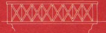
Howe: d'après William Howe, du Massachusetts. Les poteaux verticaux sont en acier.
