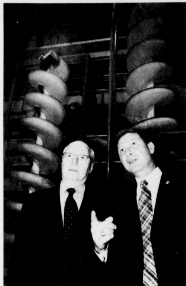
Dans l'usine-laboratoire de Corem à Québec, le directeur général de ce centre de recherche, Jacques Saint-Cyr, à gauche, explique au ministre de Développement économique Canada, Jacques Saada, le fonctionnement de spirales de concentration du minerai dont les chercheurs améliorent la performance pour les mines de fer.
