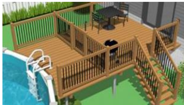
Exemple de terrasse rattachant la piscine à la résidence. La clôture empêchant l'accès à la piscine doit toujours avoir au moins 1,2 m de hauteur.
