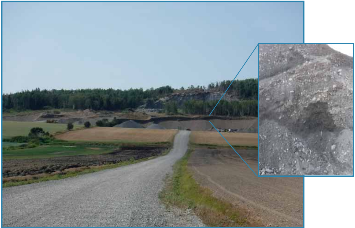
PHOTO 9 – Vaste exploitation commerciale exposant des faces de 10 à 12 m de hauteur composées de galets (40 à 60 %) et de cailloux (5 à 15 %) dans une matrice de sable moyen à grossier plus ou moins bien stratifiée (site 494, 22C03).
