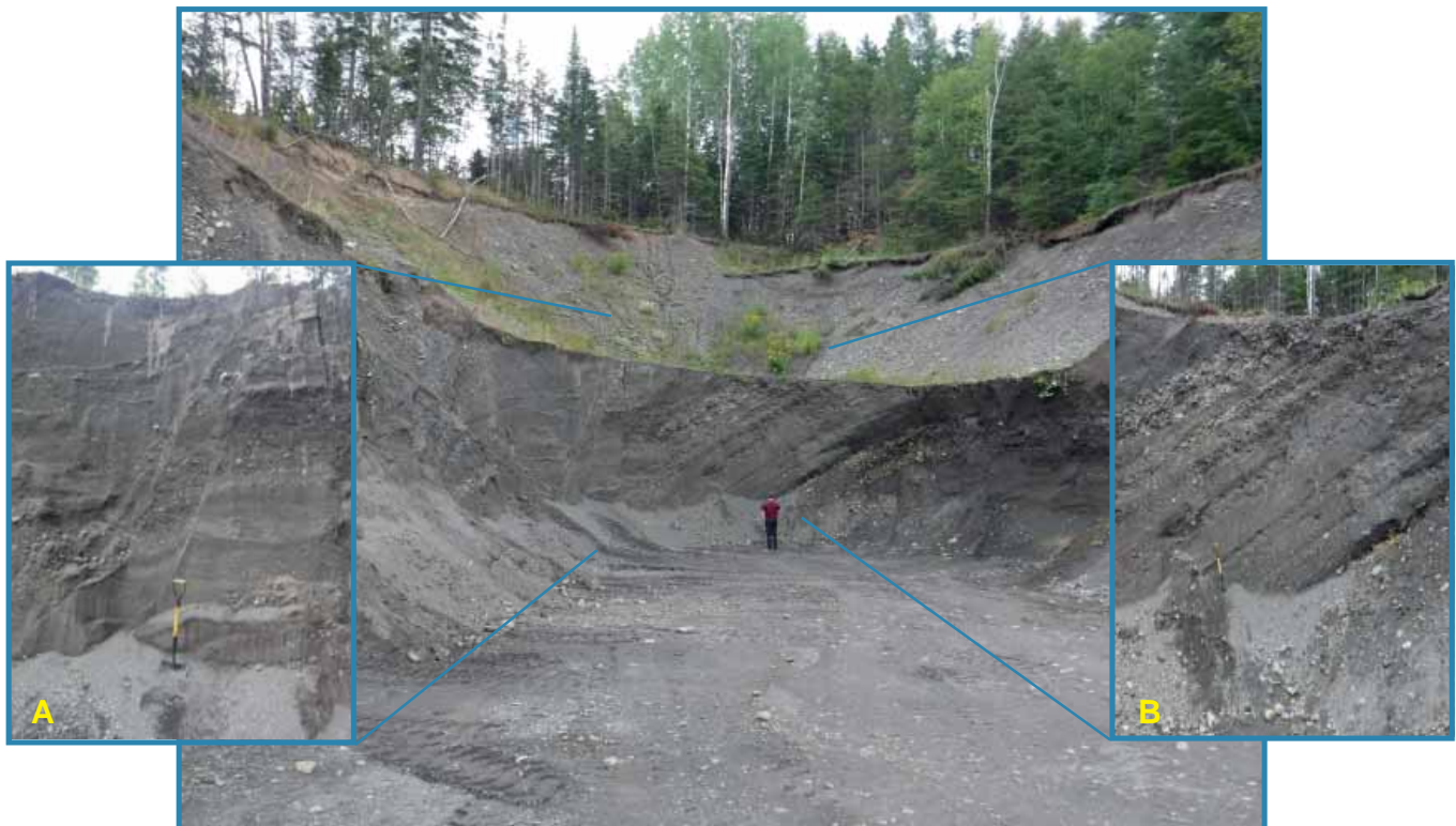
PHOTO 6 – Face de 10 à 12 m de haut composée de sable de granulométrie diverse avec des interstratifications de gravier. Présence de failles (A) et de stratifications obliques (B) (site 530, 22C03).
