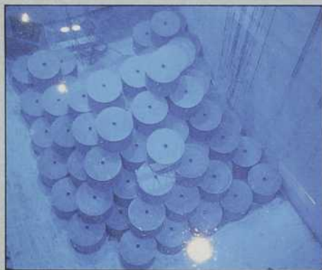
Les paniers contenant les grappes radioactives sont empilés au fond de la piscine avant le transfert dans les silos.
