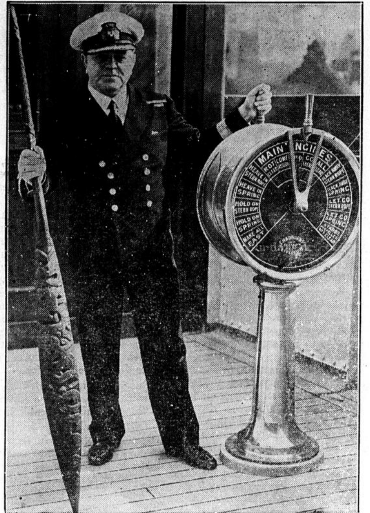
Navigation primitive et navigation moderne. Le capitaine W.-G. BUSK-WOOD, commandant de l'"Empress of Britain", qui vient de terminer à New-York sa huitième croisière autour du monde, en présente ici les deux symboles—l'appareil qui sert à donner les ordres à la chambre des machines du puissant paquebot et une pagaie Maori de la Nouvelle-Zélande, qui fut présentée au capitaine Busk-Wood par le maire de Melbourne, Australie, lors de l'escale du "Britain" dans ce port. (Photo C.P.R.)
