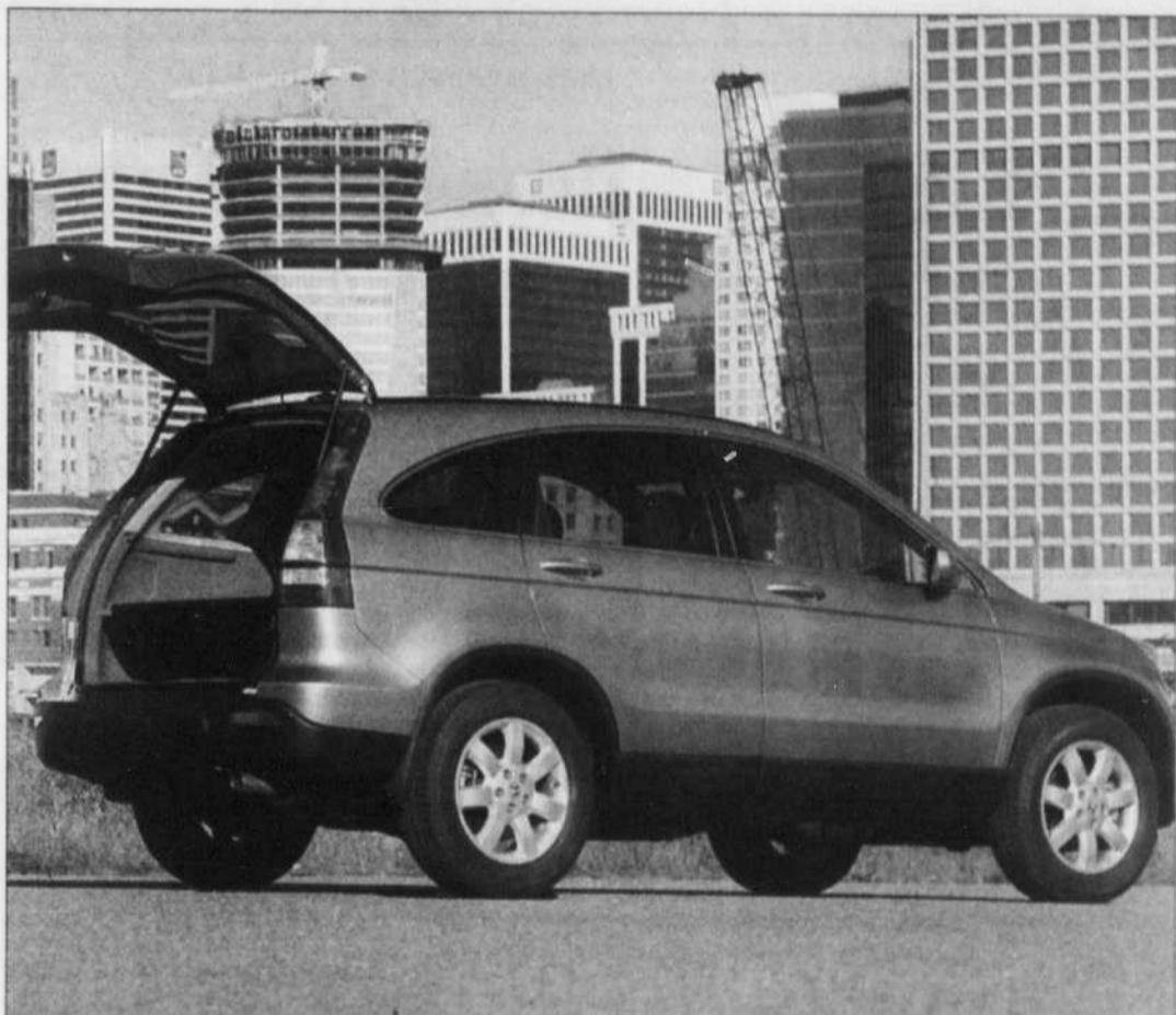
Sur le modèle 2007 du Honda CR-V, la roue de secours, autrefois accrochée sur la porte arrière, loge dorénavant sous le plancher de la soute, à l'arrière, et l'ouvrant est devenu un hayon qui s'ouvre vers le haut.
