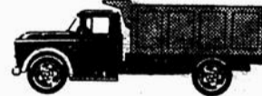
Nouveau Dodge D500 avec carrosserie à bascule, 6 ou V-8, 17,000 lb. P.B.V. max.
