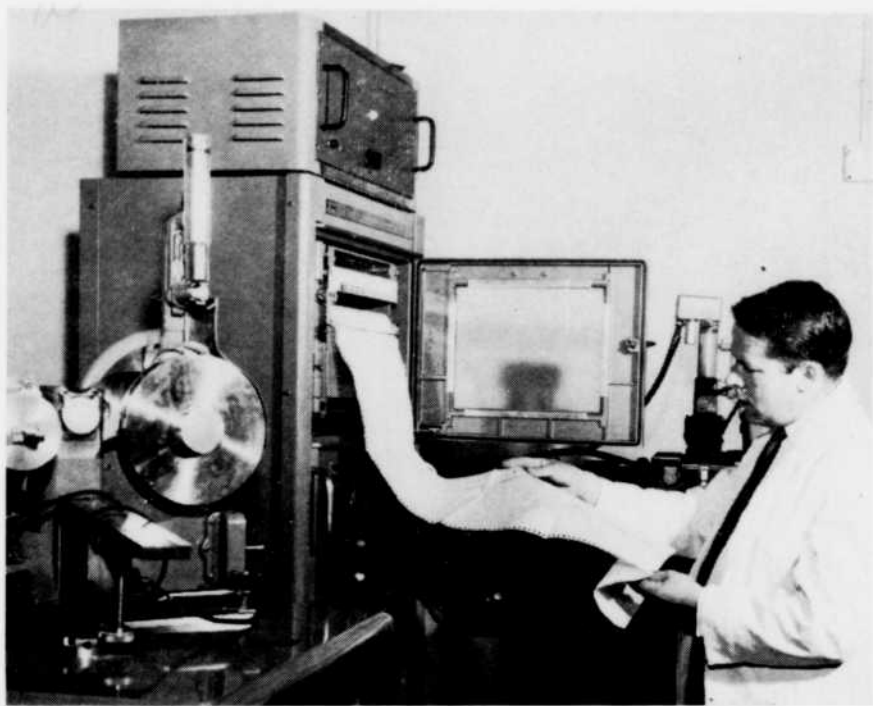
Fig. 2 — M. Guy Perreault, à l'appareil aux rayons-X, examinant les résultats d'analyse de minerai de columbium.
