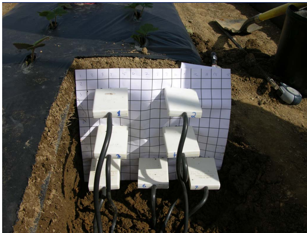
Figure 64. Les sept sondes TDR insérées dans la demi-butte.
