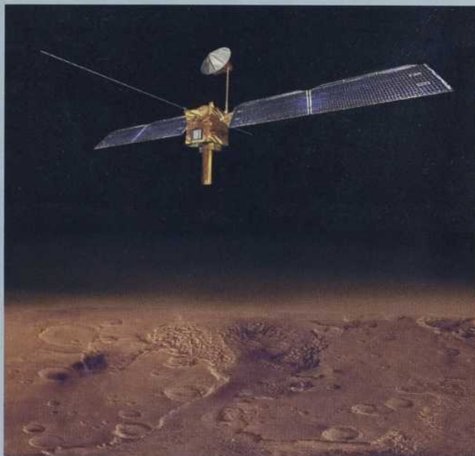
Illustration de l'orbiteur Mars Reconnaissance dont le lancement est prévu pour 2005. Il réalisera une cartographie encore plus précise de la planète grâce à plusieurs instruments dont une caméra haute résolution.
