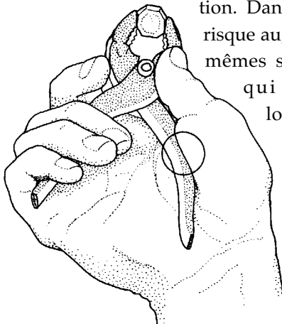
Fig. 2.18 Une poignée mal conçue peut comprimer les tendons à la base du pouce.
