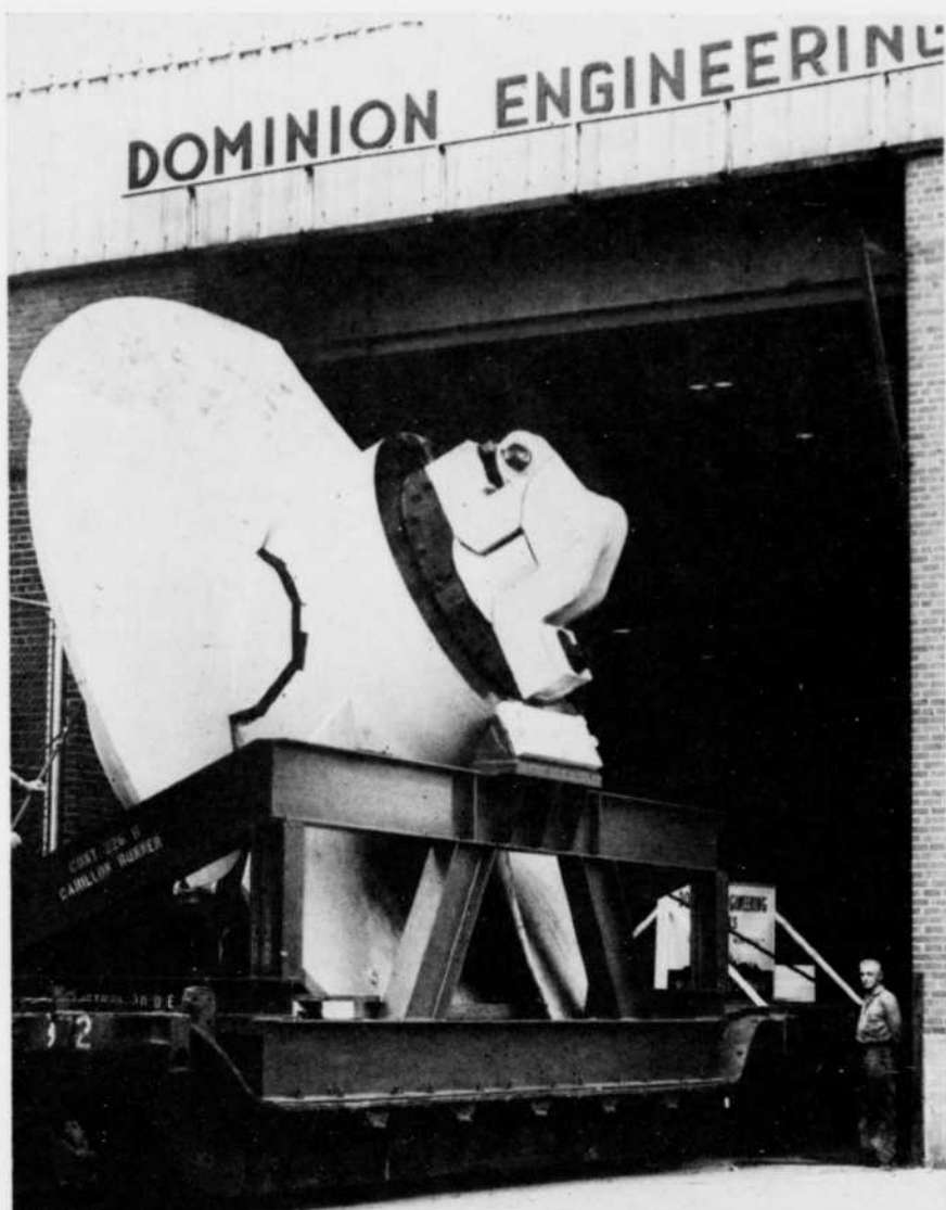
La première couronne mobile de type Kaplan fabriquée par la compagnie Dominion Engineering pour la centrale hydroélectrique de Carillon, sur l'Ontario, a été livrée récemment. Treize autres seront expédiées à des dates prévues au cours de 1962. Cette couronne d'une puissance de 60,000 h.p. est une des plus volumineuses jamais expédiées après assemblage complet à l'usine.
