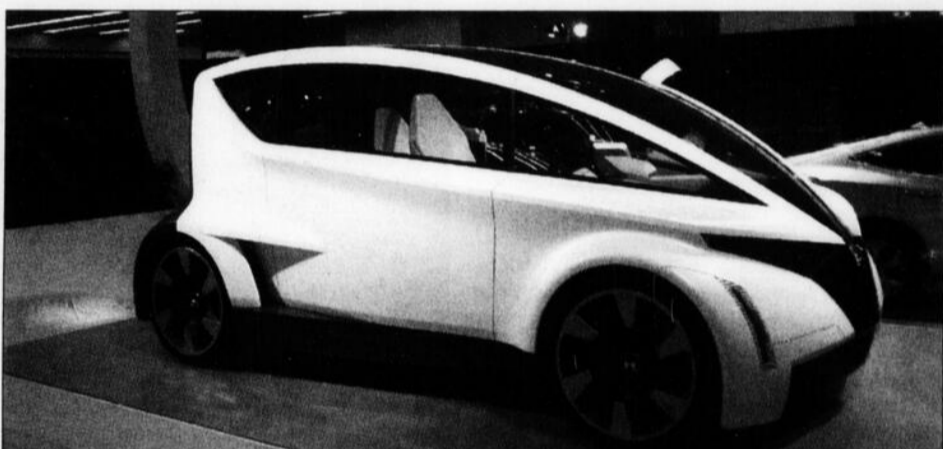
Le concept P-NUT de Honda permet d'illustrer ce que pourrait être un coupé urbain ultracompact du futur. Au choix, le groupe propulseur est un moteur hybride électrique à combustion interne ou un moteur tout électrique à batteries.
