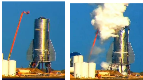
Le Starship MK. 1 est détruit lorsque le sommet de ses réservoirs explose.
