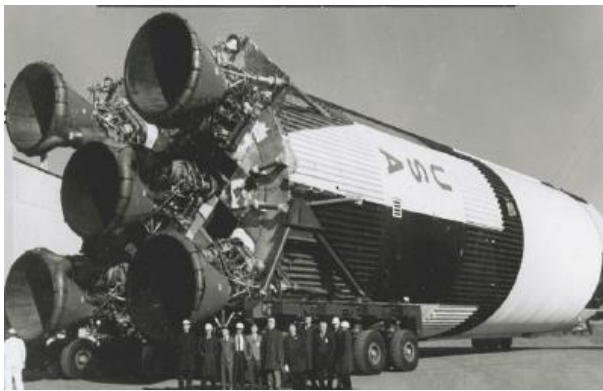
Le premier étage d'une fusée Saturn V, avec ses cinq moteurs-fusée F-1.
