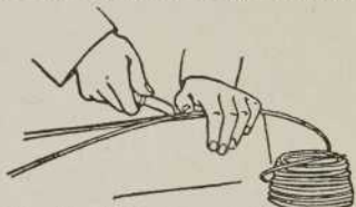
Fig. 31—Sectionnement d'une longueur suffisante de mèche.
