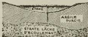
Fig. 159—Les étangs provenant du pressement d'une couche de matériel mou peuvent subir un assèchement à l'aide d'une charge profonde.
