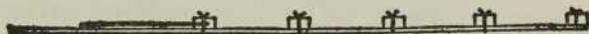
Fig. 108—La grosseur de chaque cartouche et son éloignement des autres sur la latte, varient selon les conditions du terrain.
