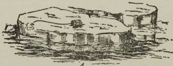
Fig. 118—Paquet de cartouches muni d'une mèche et d'une amorce, le tirage en surface ( mudcapping ) des morceaux de glace flottante.
