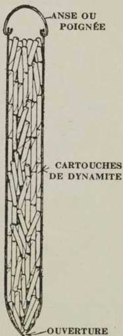
Fig. 147—Enveloppe cylindrique devant contenir la dynamite ou la nitroglycerine.
