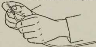
Fig. 33—Disposition de l'amorce sur l'extrémité de la mèche.
