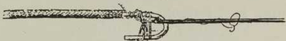
Fig. 46—Excellente méthode de raccordement des fils d'une amorce électrique à un fil principal.
