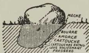
Fig. 128—Méthode appropriée de disposition de la charge et de chargement d'un galet à briser ou à déplacer à l'aide d'un tirage sous-latéral ( snake-hole ).
