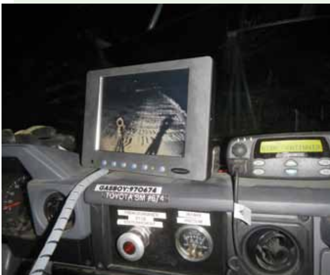
La caméra active Visi+ est installée sur les véhicules de sauvetage du site minier Raglan.
