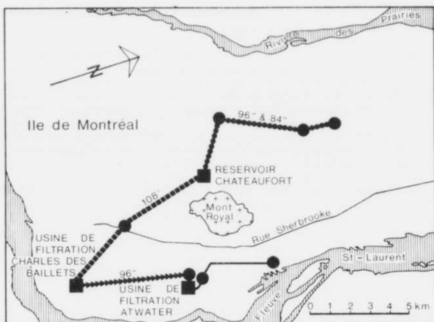
Figure 2 — Exemple d'utilisation du moyen espace: les nouvelles conduites maitresses de l'aqueduc de Montréal, dont la profondeur atteint 70 m par endroits.
