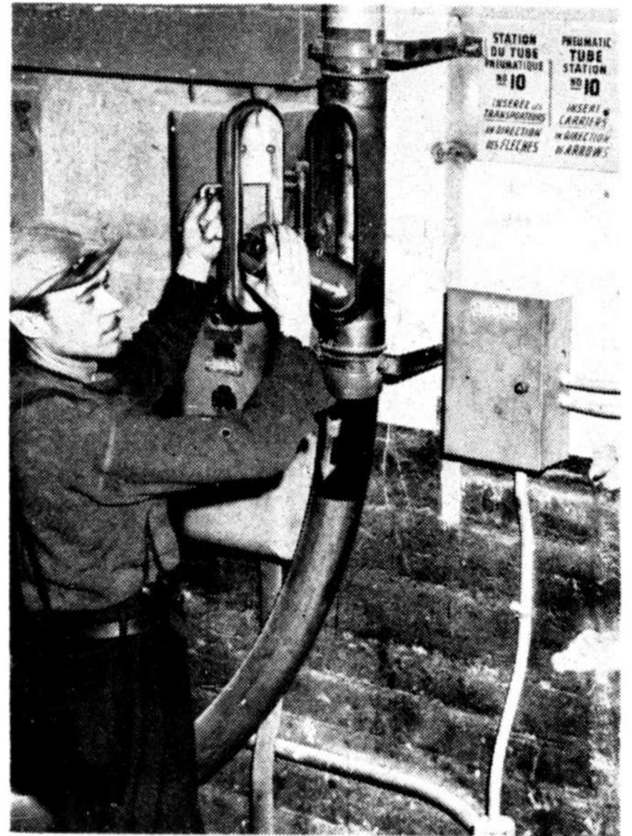
APRÈS AVOIR MOULÉ L'ÉCHANTILLON, le responsable de la fournaise le place dans un cylindre qu'il introduit dans le tube pneumatique qui l'amènera au laboratoire.
