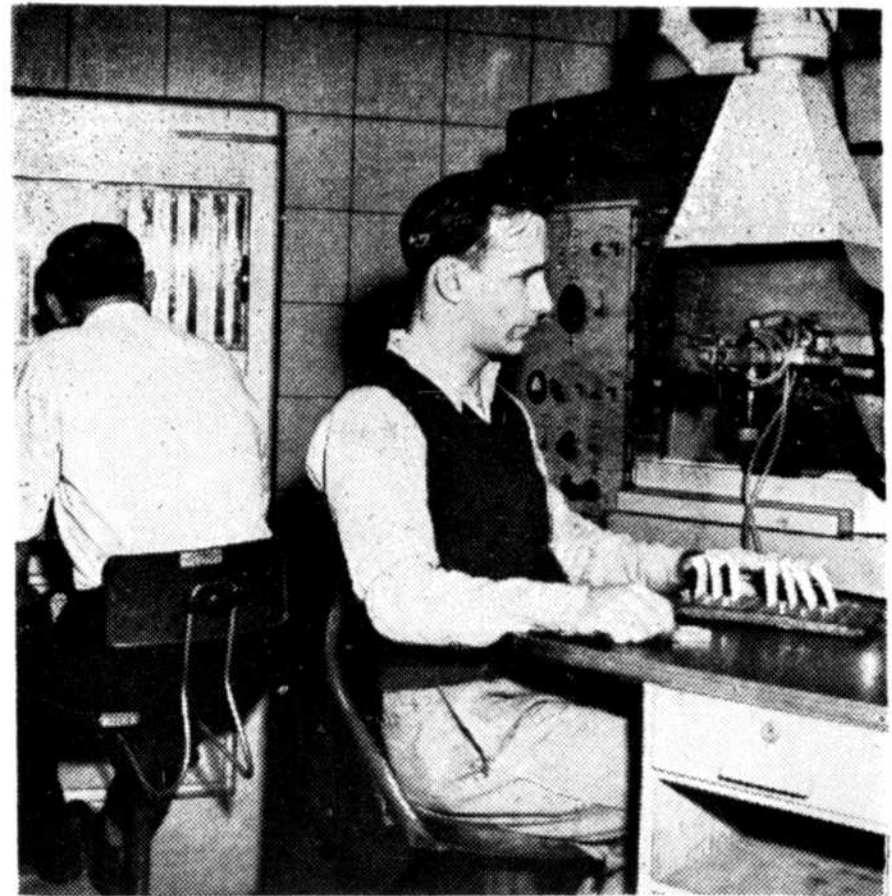
L'ANALYSE DE L'ECHANTILLON est faite, à droite, et la lecture de la composition, à gauche, le tout se fait en quelques secondes.
