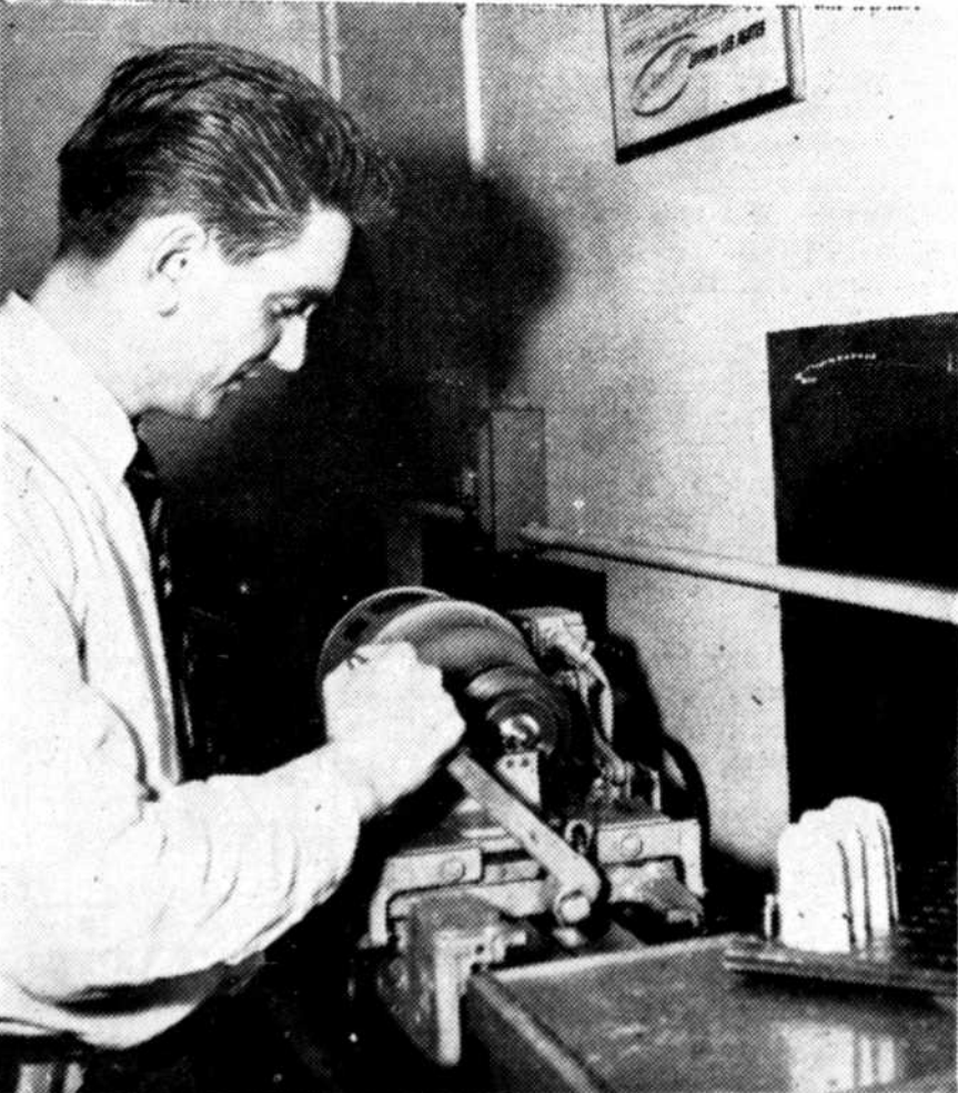
LE POLISSAGE DE L'ELECTRODE est fait par un autre technicien et précède immédiatement l'analyse.
