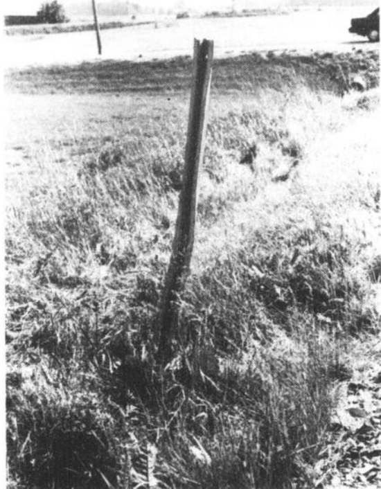
Sous la force de l'impact, le panneau de signalisation a été complètement arraché.
