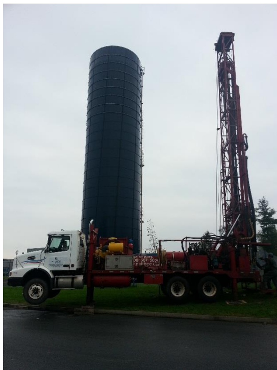
Figure 2 : Foreuse rotative (modèle Speedstar)
