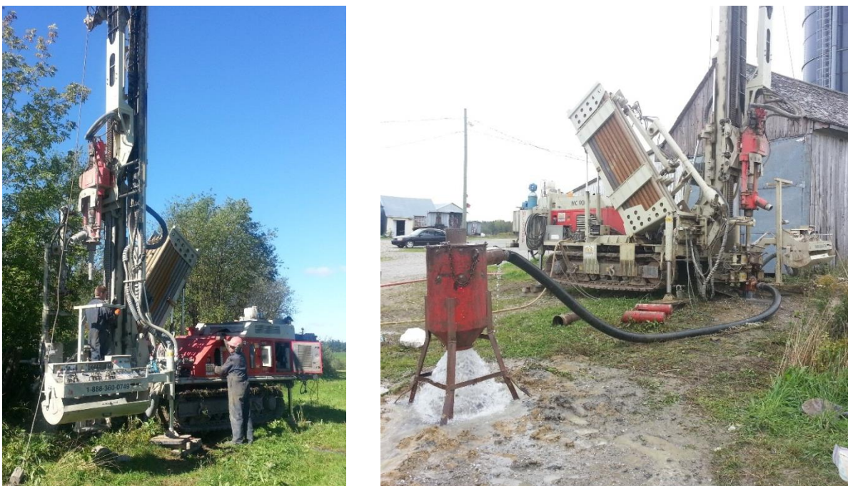
Figure 3 : Foreuse rotative sur chenilles (modèle Comacchio MC-900P)
