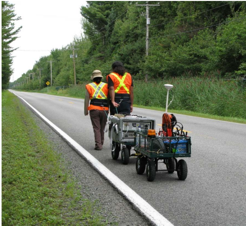
Figure 10. Dispositif mobile d'échantillonnage du CO 2 atmosphérique au niveau du sol (concentrations et ratios isotopiques). Deux opérateurs tractent un spectromètre laser (premier chariot) qui enregistre des mesures en continu. Il est alimenté par un set de batteries à décharge profonde (second chariot). Un GPS enregistre les positions spatiales des mesures.
