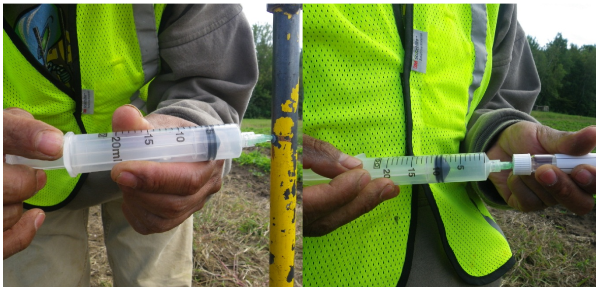
Figure 18. Prélèvement des gaz de sol. Une sonde (tube métallique avec en son centre un fin capillaire) est enfoncée dans le sol à une profondeur de 50 cm. Après la purge du système, un volume de gaz est prélevé à la seringue et injecté dans des contenants.
