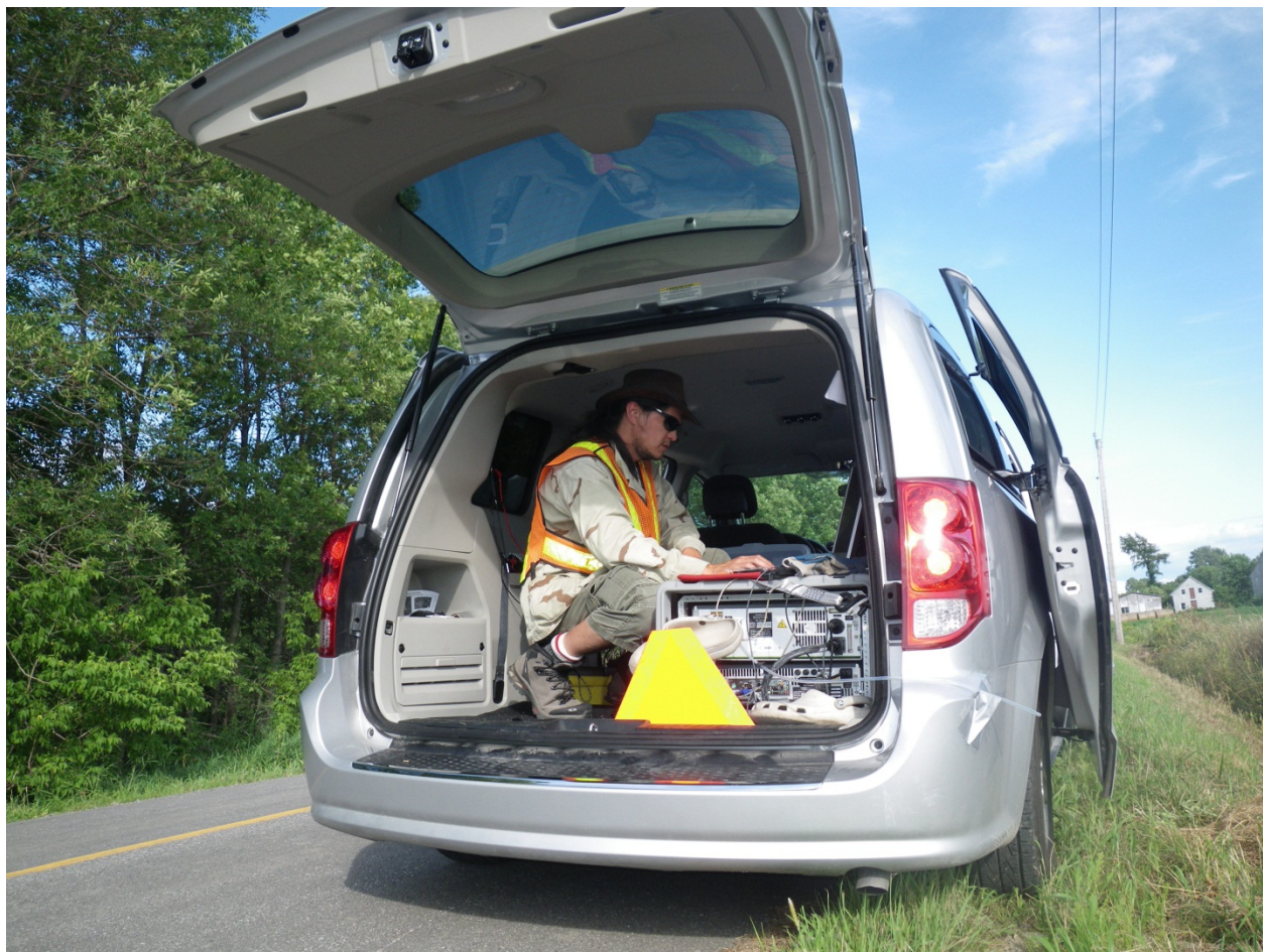
Figure 11. Échantillonnage du CO 2 atmosphérique utilisé en 2011. Un véhicule est stationné le long de la route. Le spectromètre laser est embarqué à l'arrière du véhicule. Il est alimenté par des batteries 12v. L'entrée d'air est visible à l'arrière droit.
