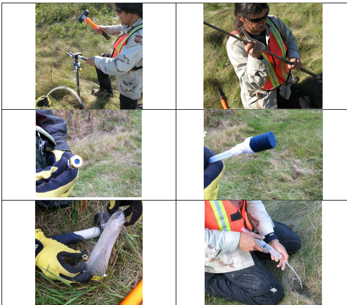
Figure 12. Stations permanentes d'échantillonnage des gaz de sol. Un trou de 60 cm est effectué dans le sol avec un emporte-pièce (en haut, à gauche) par pallier de 5 cm. A chaque pallier, le matériel est chassé du tube (en haut, à droite). Un tube est installé dans le trou. Une de ses extrémités est terminée par un septum (au milieu, à gauche) et l'autre par un matériel poreux utilisé en aquariophilie (au milieu, à gauche). Le tube est installé. Un sable poreux remplit le fond du trou (les 10 derniers cm) et le reste du trou est rebouché avec le matériel d'origine (en bas, à gauche).
