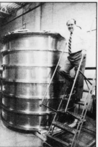
Gilles Nantel, directeur général de l'usine d'Industrie USP qui a produit le tamis mesurant 90 pouces (7 pieds et 6 pouces) de diamètre sur 91 pouces de haut.
