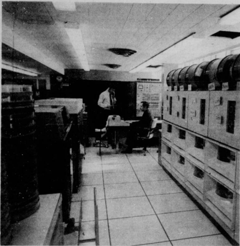
La banque d'information de la base d'entretien d'Air Canada. En quelques minutes, l'ordinateur donne le "dossier médical" d'un avion ou d'une pièce.
