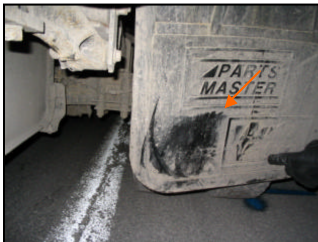
photo 7 traces sur le garde boue arrière droit
