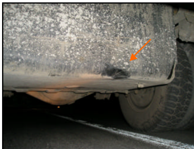
photo 8 traces sur le réservoir de carburant
