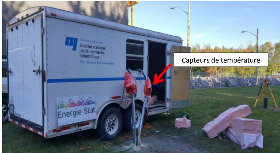
Figure 8 : Vue globale des équipements d'essai TRT et logistique INRS-ES.
