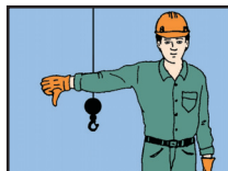
10. Abaissement de la flèche
