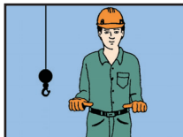
14. Rentrer la flèche (Flèche télescopique)
