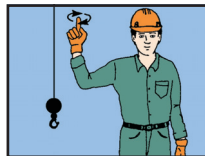
7. Levage de la charge
