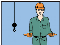
13. Sortir la flèche (Flèche télescopique)
