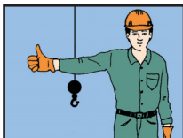
9. Relevage de la flèche
