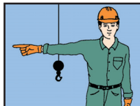
15. Rotation (L'index indique la direction)
