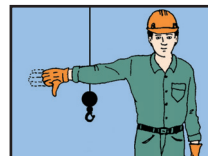
12. Abaissement de la flèche et levage de la charge
