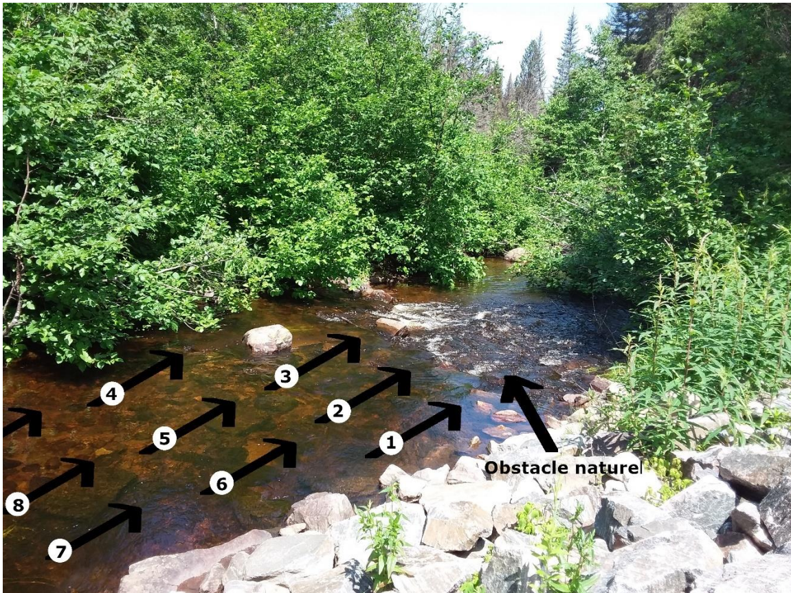
Figure 7 : Exemple de la chronologie des passages de l'anode couvrant systématiquement toute la largeur du cours d'eau d'une station débutant près d'un obstacle naturel.
