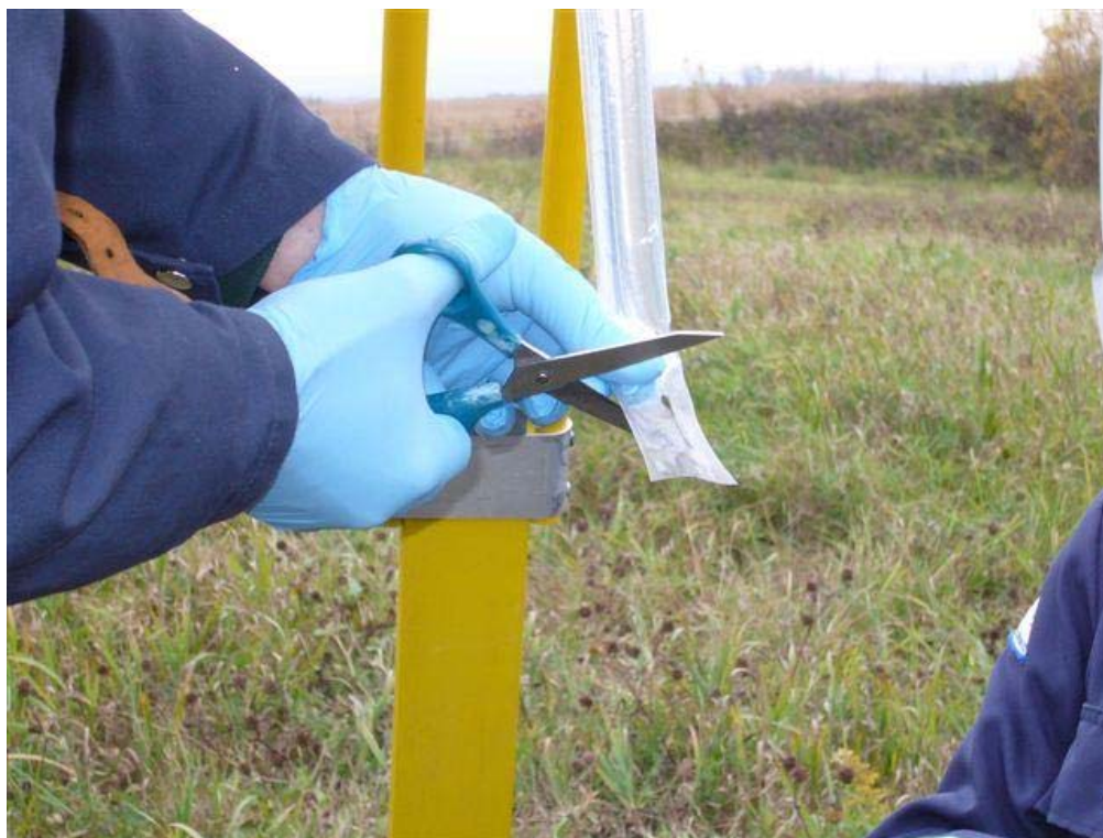
Photo 10. Opération de récupération de l'échantillon dans un sac à diffusion : les gants et les ciseaux doivent être exempts de contaminants (MDDEP, 2008)
