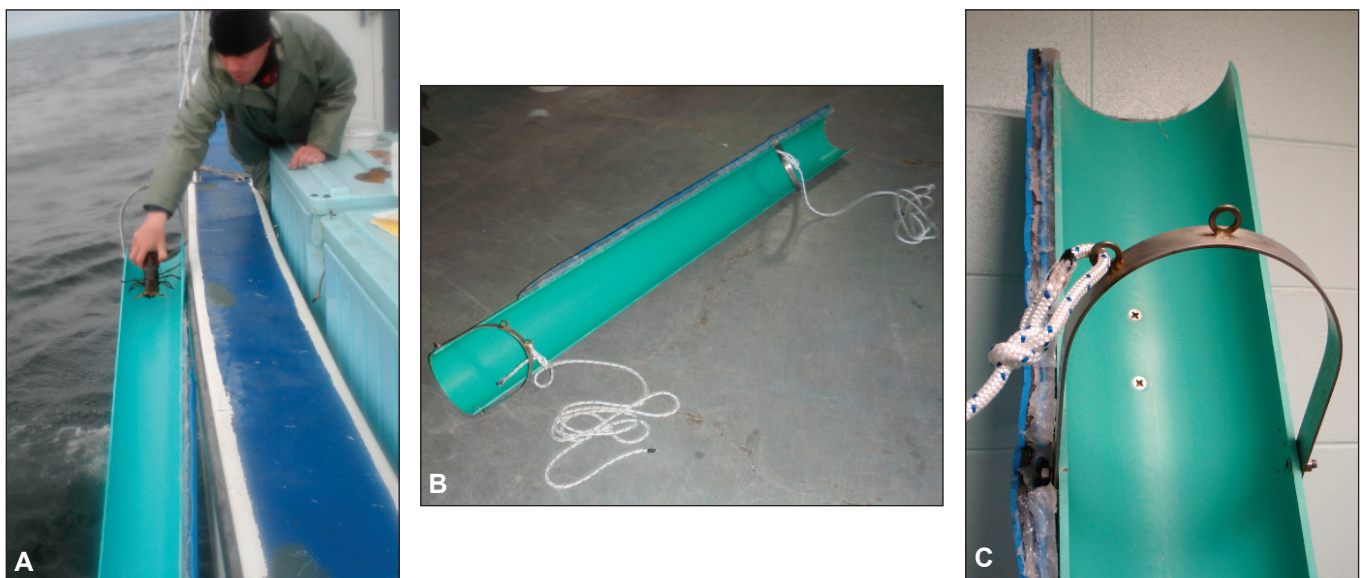
Figure 2. A : dépôt du homard sur la glissière; B : ensemble du dispositif; C : arceau.
