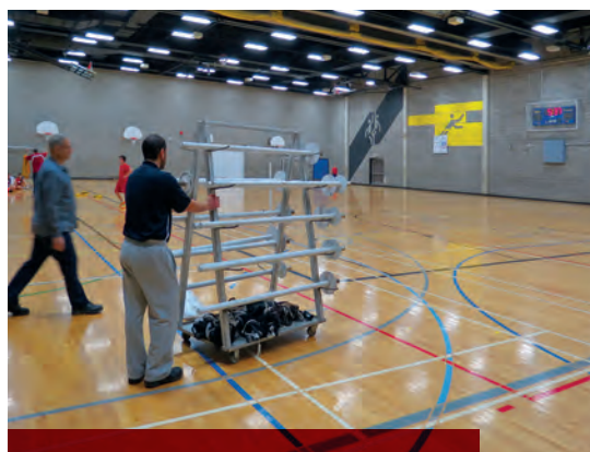
Ce chariot aide au déplacement des poteaux. Il réduit les accidents lors de la manutention et protège le plancher.
