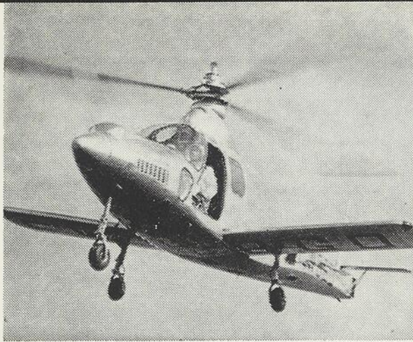
L'hélicoptère FARFADET, type convertible avec plans fixes réduits et réacteur indépendant du rotor.
