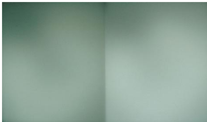
FIGURE 26 ÉVALUATION VISUELLE DE L'UNIFORMITÉ DE LA LUMINANCE D'UN NÉGATOSCOPE (non conforme)
